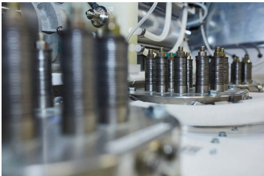
Der Elektrolyseur zerlegt mit Elektrizität Wasser in Wasser- und Sauerstoff. Wasserstoff kann dosiert ins Erdgasnetz eingespeist werden
